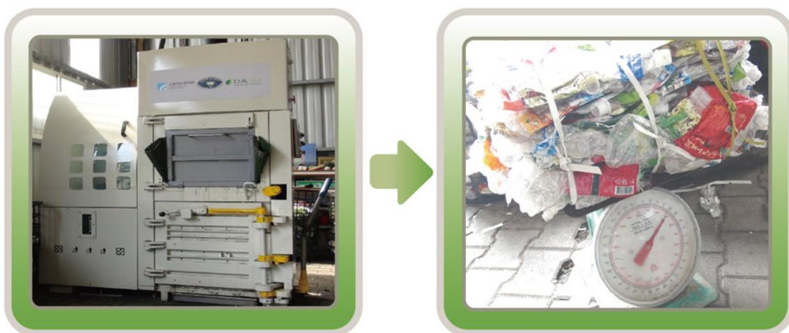
大愛感恩科技在2014年進行增設環保容積壓縮機運輸GHG減量評估，基於取得的資訊進行評估，未設置環保容積壓縮機，每件180公分\*230公分的灰色毛毯排放溫室氣體排放量為1.35kg二氧化碳當量（CO<sub>2</sub>e），設置環保容積壓縮機，每件180公分\*230公分的灰色毛毯排放溫室氣體排放量為0.25kg二氧化碳當量（CO<sub>2</sub>e），增設環保容積壓縮機大幅減少運送次數，可減少81%的溫室氣體排放，帶來相當大的成效。
