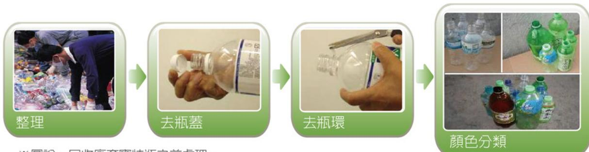
由於環保菩薩的細心分類，使瓶片還原酯粒的製程，因減少了諸多雜質，在後續抽紗的流程中提升良率，不僅減少斷紗的情形，也延長濾網耗材的使用，加上廠商專業的技術，相較一般PET回收不良率約在15-20%，已降至10%以下，進而生產出高品質的環保紗。
